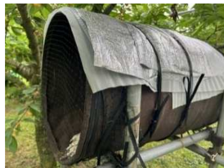
■ 断熱材を使用した事例 (ドラム缶は高温対策が必須)
