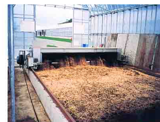
④攪拌移送機により混合され移動します。
