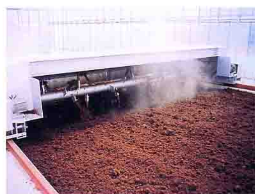
⑦攪拌移送機で移動しながら乾燥します。
