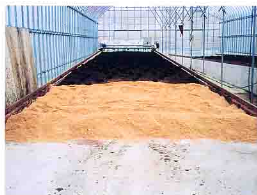
①乾燥堆肥を投入口に敷きつめます。 (写真では、鮮明な写真にするためオカクスを使用し撮影しました。)
