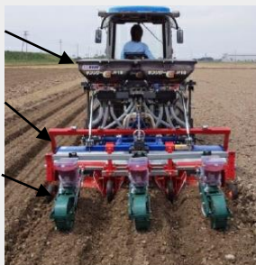
図2 うね内部分施用播種機とうね断面模式図
