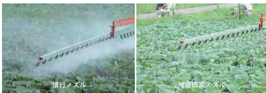
ブームスプレーヤでの飛散低減ノズルの飛散低減効果調査事例
